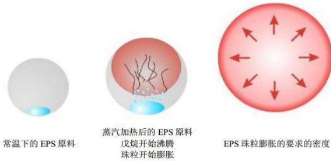
图4 EPS原料发泡示意图
